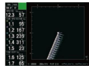
Los vectores marea pueden ser mostrados en la derrota del barco, a intervalos especificados por el operador.
